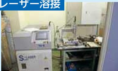
異種金属の溶接実験用の機材です。この溶接機では、アルミと鉄、銅とステンレスなど融点温度の違う金属を接合する実験が可能となっており、これからの技術革新を感じました。
