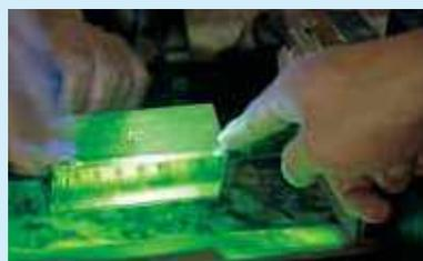
試験体に磁界を発生させ、磁界の乱れから傷の場所を見つけます。
