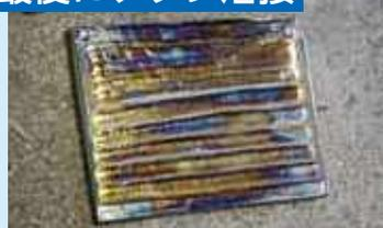
溶接金属の中でも最も難易度が高いとされる物で主にTIG溶接(Tungsten Inert Gas)でおこなわれています。
