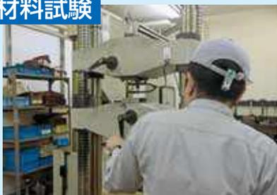
溶接した金属の強度を計測する引っ張り試験の様子。
