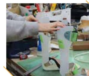
冷えたらモデルから外し不要部分をカット、細部を仕上げ部品を付けて完成
